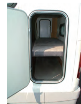
リア常設2段ベット 上段1840×660×700mm 下段1840×660×620mm ベットの収納は外部バケツドアからも出し入れできます。
