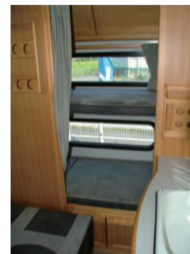
リア常設2段ベット 上段1840×660×700mm 下段1840×660×620mm ベットの収納は外部バケツドアからも出し入れできます。
